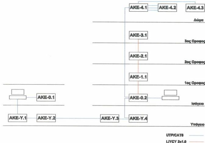
Το Σύστημα είναι σχεδιασμένο για να παρέχει από ένα κεντρικό σημείο την παρακολούθηση της λειτουργίας, την ανίχνευση σφαλμάτων και βλαβών, την μέγιστη εξοικονόμηση ενέργειας και τις πληροφορίες προληπτικής συντήρησης των ηλεκτρομηχανολογικών και άλλων εγκαταστάσεων του κτιρίου.
